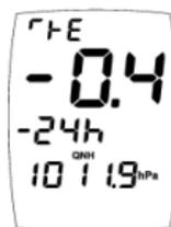
Angezeigt wird der Luftdruck von vor 24 Stunden, also von 11 Uhr am Vortag (30. April). Das Instrument vergleicht den letzten, zur vollen Stunde (hier, 11 Uhr, am 1. Mai, 1011,0) gemessenen Luftdruck mit dem von vor 3 Stunden und zeigt die Differenz an. Man stellt fest, dass der Luftdruck innerhalb 24 Stunden um 0,4 hPa gefallen ist.
