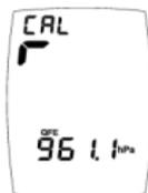
Wählen Sie den unteren Block aus, wechseln dann in den Messmodus für die QFE Höhe (blinkt) und drücken anschließend die Taste . Daraufhin blinkt im oberen Block. Lassen Sie die Taste los, sobald Sie in den Kalibrierungsmodus eintreten (benachbartes Bild).
