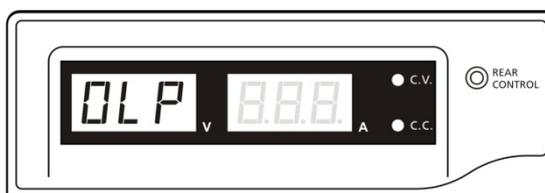
Zum Zurücksetzen dieser Warnanzeige schalten Sie das Netzteil aus und trennen Sie alle angeschlossenen Lasten vom Netzteil.
