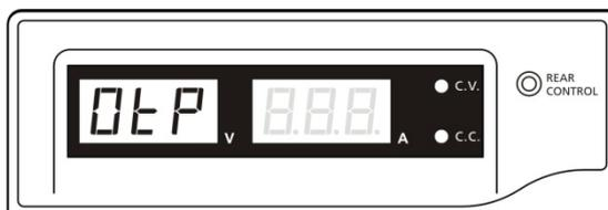
Bei erscheinen dieser Warnung, schalten Sie das Netzteil aus und trennen Sie alle angeschlossenen Lasten vom Netzteil.
