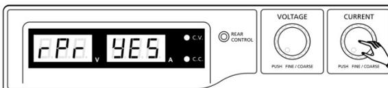
Drücken Sie zum Abschluss den Spannungsreglerknopf um den **MENU**-Modus zu verlassen.
