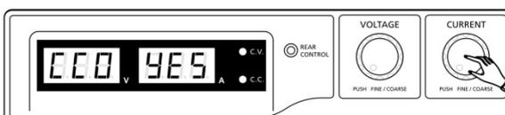
Drücken Sie abschließend den Spannungsreglerknopf zum Verlassen des **MENU**-Modus.
